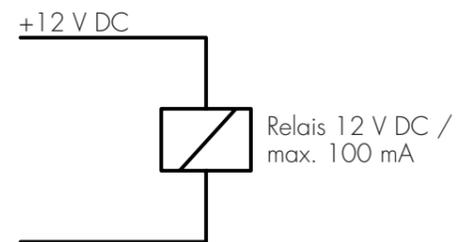
Bild 4 Beispiel für einen Relaisanschluss
