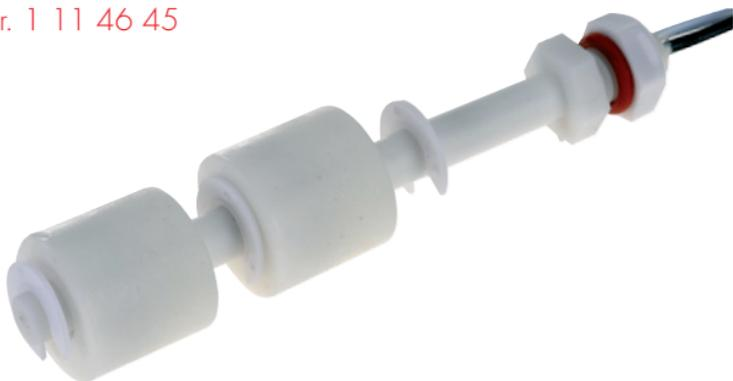
Dieser Schwimmerschalter mit zwei Schaltkontakten, eignet sich für die Überwachung von Flüssigkeitsständen in nicht aggressiven Medien (z.B. Wasser). Bei steigendem Flüssigkeitsstand wird der Schwimmer angehoben und betätigt einen Magnetschalter. Abhängig von der Montage des Schwimmerschalters, kann ein Öffner bzw. Schließer realisiert werden. Übersteigt der Pegel Schwimmerschalter S2, wird zusätzlich Schwimmerschalter S1 aktiviert (Alarmfunktion).
